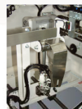
エアシリンダ駆動により内フラップ、外フラップを折り込み、製函を確実に行います。
